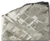
železný meteorit – řez Widmanstättenovy obrazce
